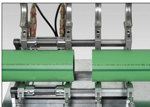
Delarna som skall svetsas fixeras och centreras
