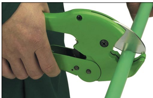
Avklippning av röret
