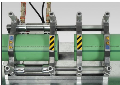
Delarna som skall svetsas fixeras och centreras
