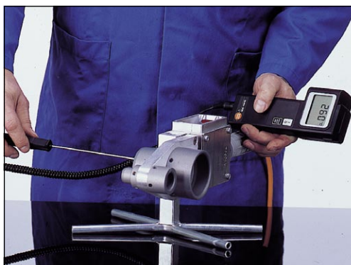
Temperaturkontroll med ytmätningssinstrument
